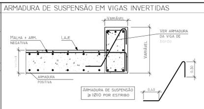
**ARMADURA DE SUSPENSÃO EM VIGAS INVERTIDAS**
