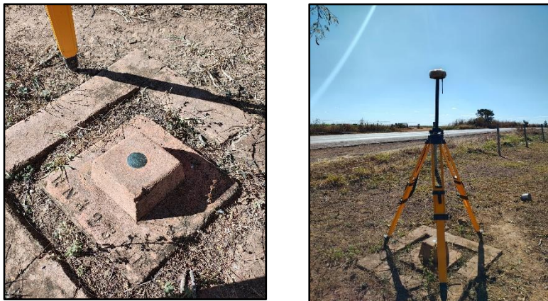
Figura 14: Estacionamento da base GNSS sobre o marco geodésico do IBGE 91385 (RN 3232F) para verificação das coordenadas e transporte de altitudes utilizando os métodos de (PPP).
