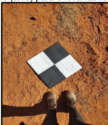
Figura 9: Ponto de controle (alvo) para o levantamento aerofotogramétrico.
