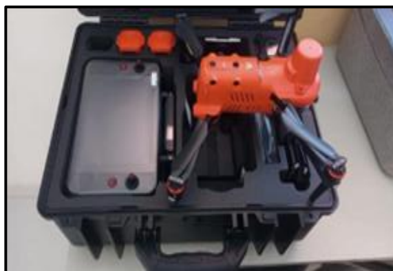
Figura 5: Drone EVO II Pro RTK V3 – Sistema RTK Integra.
