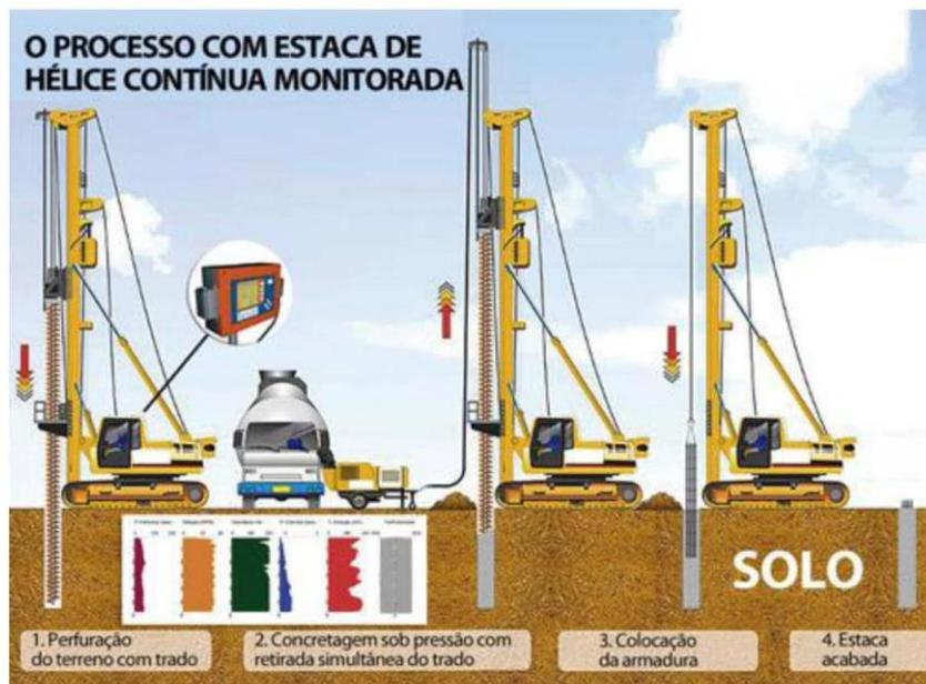
3.3 A metodologia de perfuração permite a sua execução em terrenos coesivos e arenosos, na presença ou não do lençol freático e atravessa camadas de solo resistentes com índice de SPT de 30 golpes a mais de 50 golpes, dependendo do tipo de equipamento utilizado.
