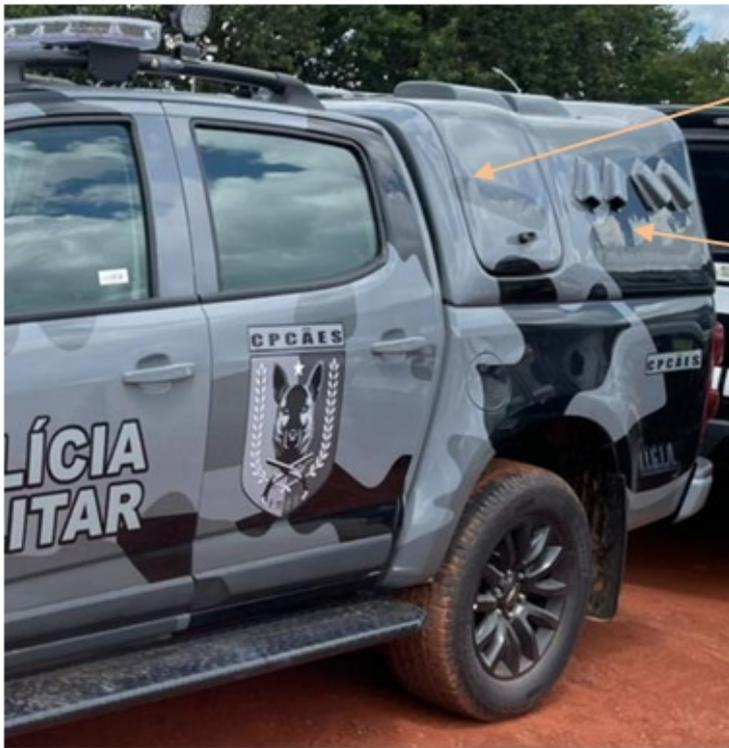
Imagem 1: modelo da carroceria coberta, com local para transporte de materiais e local para transporte de cães.
