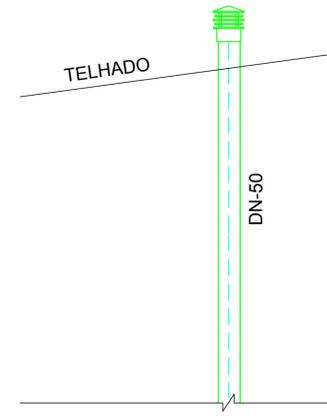
DETALHE - SAÍDA DA VENTILAÇÃO
