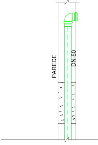
DETALHE - SAÍDA DA VENTILAÇÃO
