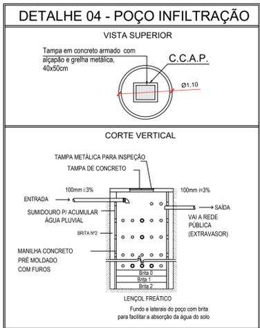
DET. 04 - POÇO DE INFILTRAÇÃO
