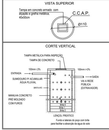
DET. 03 - POÇO DE INFILTRAÇÃO
