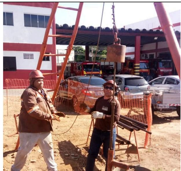
Foto.04 – Ensaio com peso/ martelo de 65kg.
