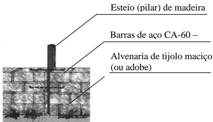
A modulação das alvenarias com “junta amarrada”, ou seja, cada fiada fica defasada meio comprimento do tijolo ou bloco em relação à fiada de baixo, uma vez que esta causa um travamento dos componentes, o que favorece muito o aumento da resistência da parede.
