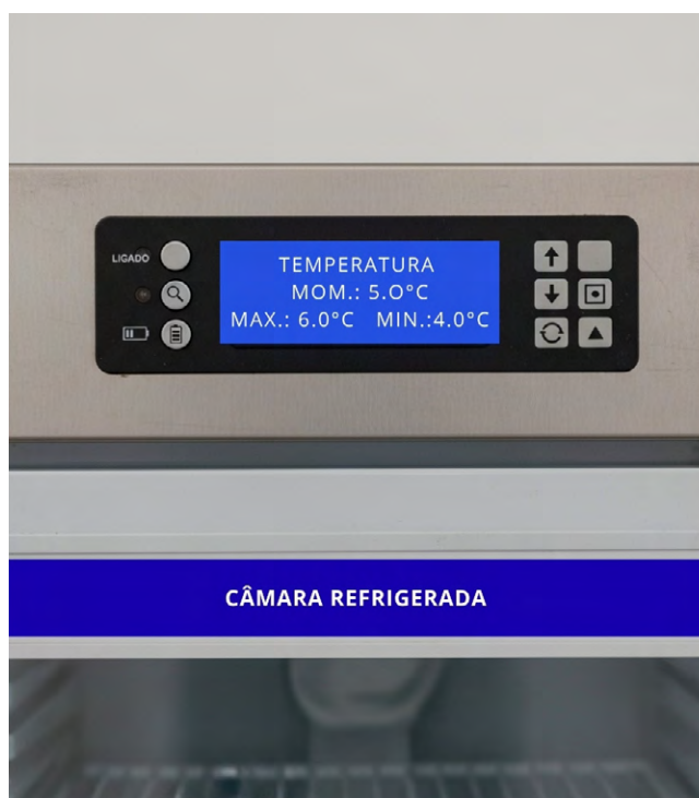
Figura 14 Registrador eletrônico do equipamento de armazenamento
