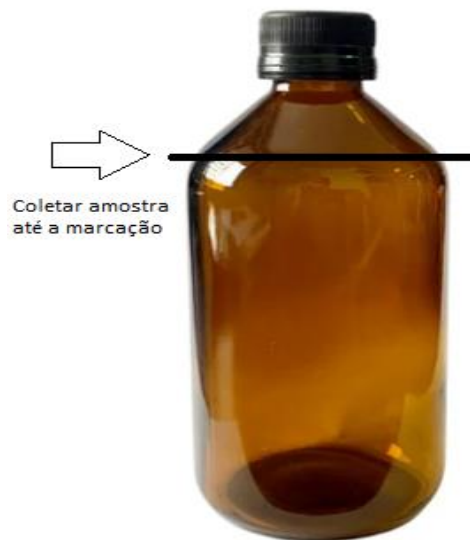
Figura 2: Marcação do frasco de 250 ml para coleta da amostra de água
