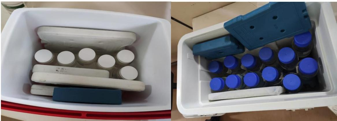
*Figura 04. Acondicionamento das amostras para envio ao Laboratório*
