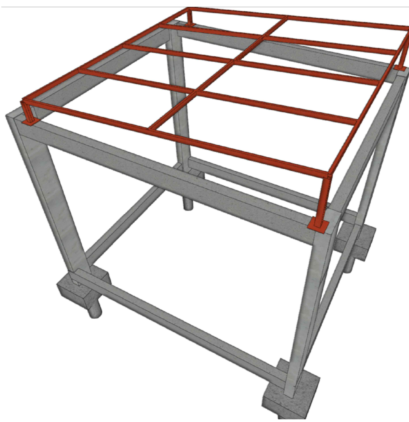
Vista 3D - Cobertura Metálica Circulação
