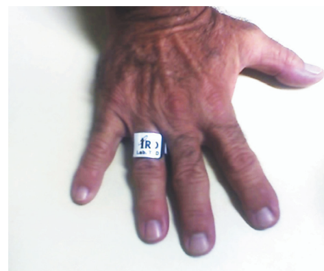
Figura 12 - Dosímetro de extremidade: anel. Geralmente utilizado por profissionais que lidam com fontes não seladas ou com equipamentos de fluoroscopia.
