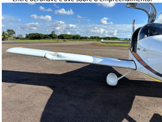
Foto 7. Foto, fornecida pela administração do Aeródromo Nacional de Aviação, demonstrando resultado de colisão entre aeronave e ave sobre o empreendimento.
