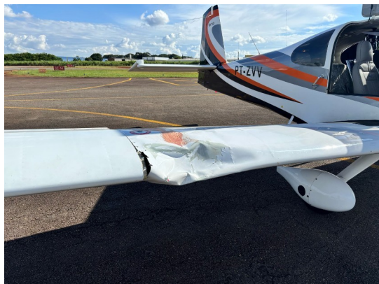
Foto 5. Foto, fornecida pela administração do Aeródromo Nacional de Aviação, demonstrando resultado de colisão entre aeronave e ave sobre o empreendimento.
