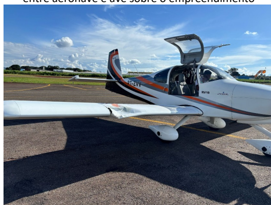
Foto 8. Foto, fornecida pela administração do Aeródromo Nacional de Aviação, demonstrando resultado de colisão entre aeronave e ave sobre o empreendimento.
