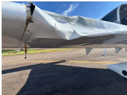
Foto 6. Foto, fornecida pela administração do Aeródromo Nacional de Aviação, demonstrando resultado de colisão entre aeronave e ave sobre o empreendimento.
