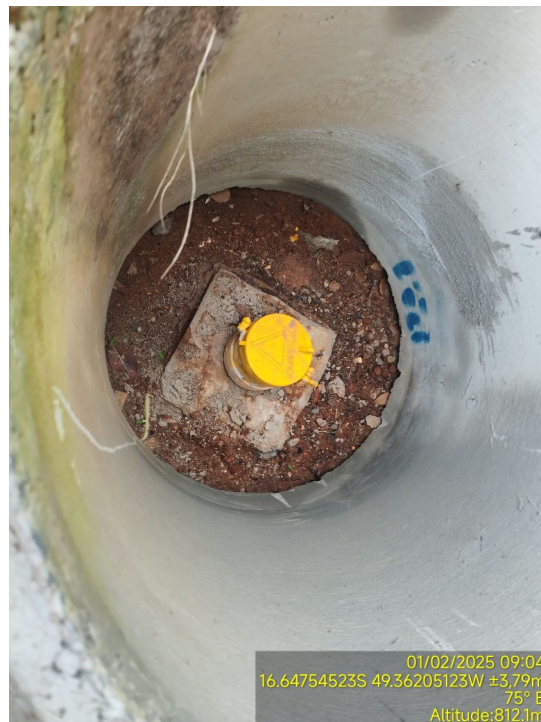
Foto 52. Detalhe de um dos poços de monitoramento.
