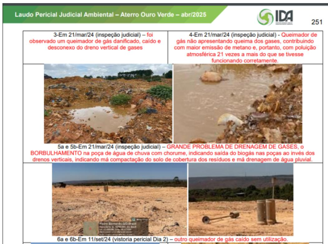
Essa falha de compactação possui correlação direta com a instabilidade no maciço de resíduos, o que veio a ser justamente a causa do deslizamento:
