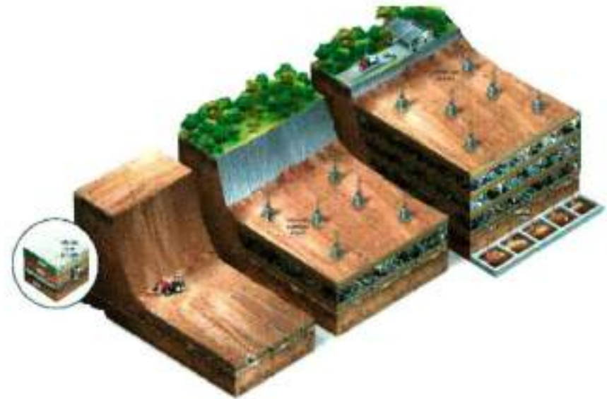
Camadas de resíduos cobertos com solo e sistema de coleta de líquidos e gases
