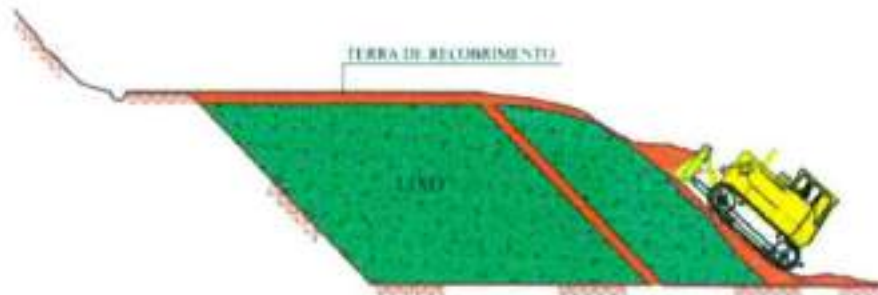
Execução da Cobertura Diária dos Resíduos com Solo
