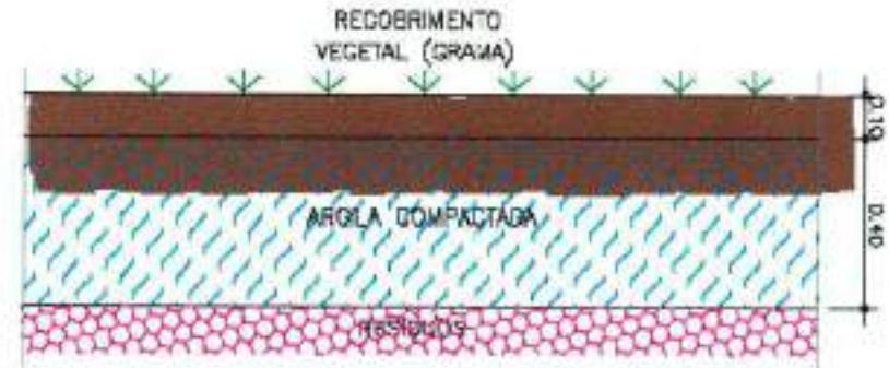
Cobertura Final do Aterro Sanitário, com plantio de grama
