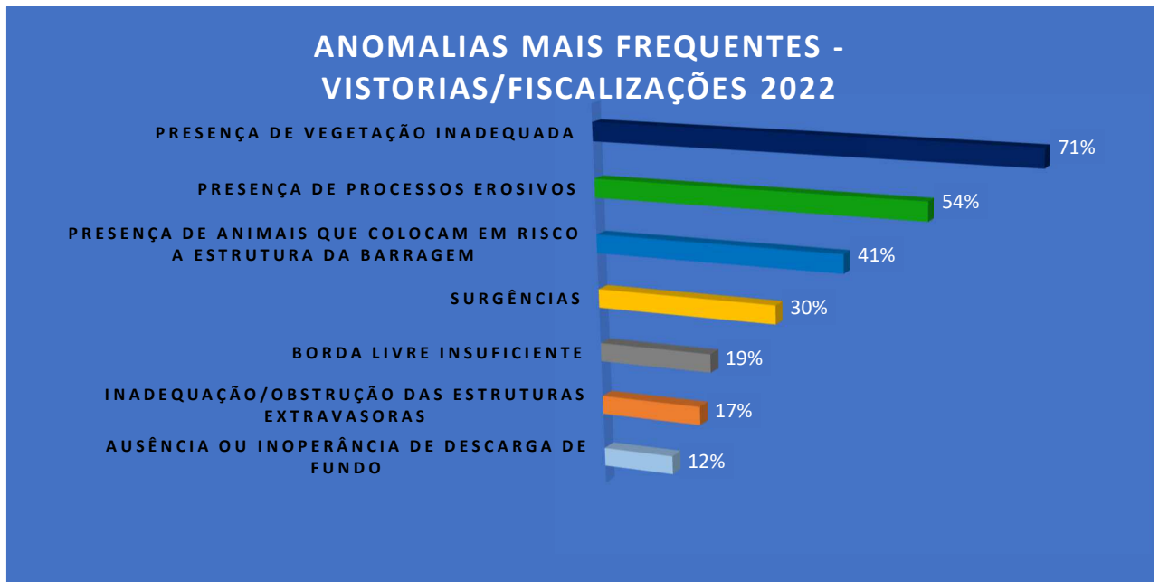
Figura 6 - Resumo das principais anomalias encontradas nas vistorias de barragens – 2022
