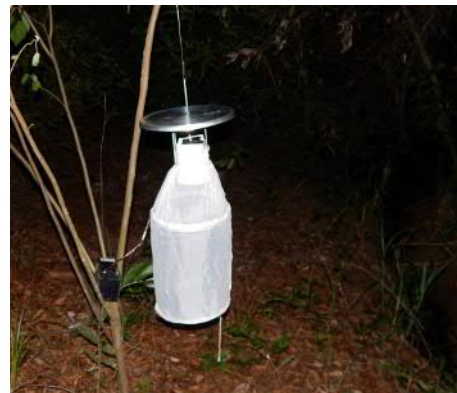
Armadilha de atração luminosa (CDC) utilizada nos trabalhos de campo para identificação dos insetos na área da PCH
