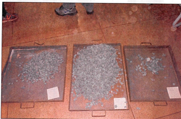
Figura 01 – Peneiramento e preparação do agregado.
