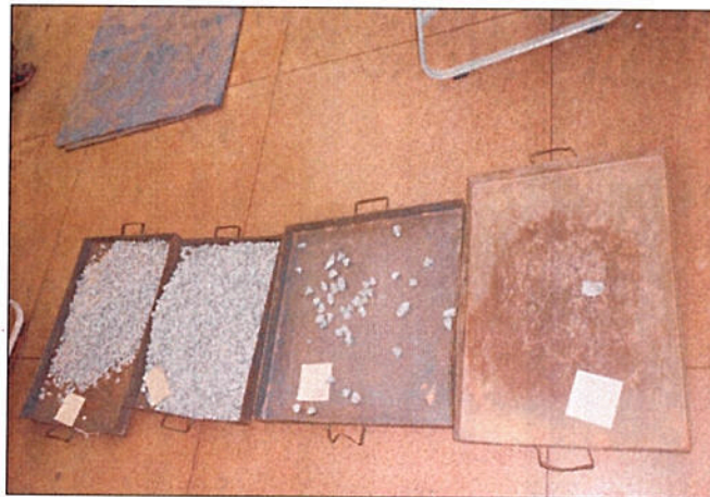
Figura 01 – Peneiramento e preparação do agregado.
