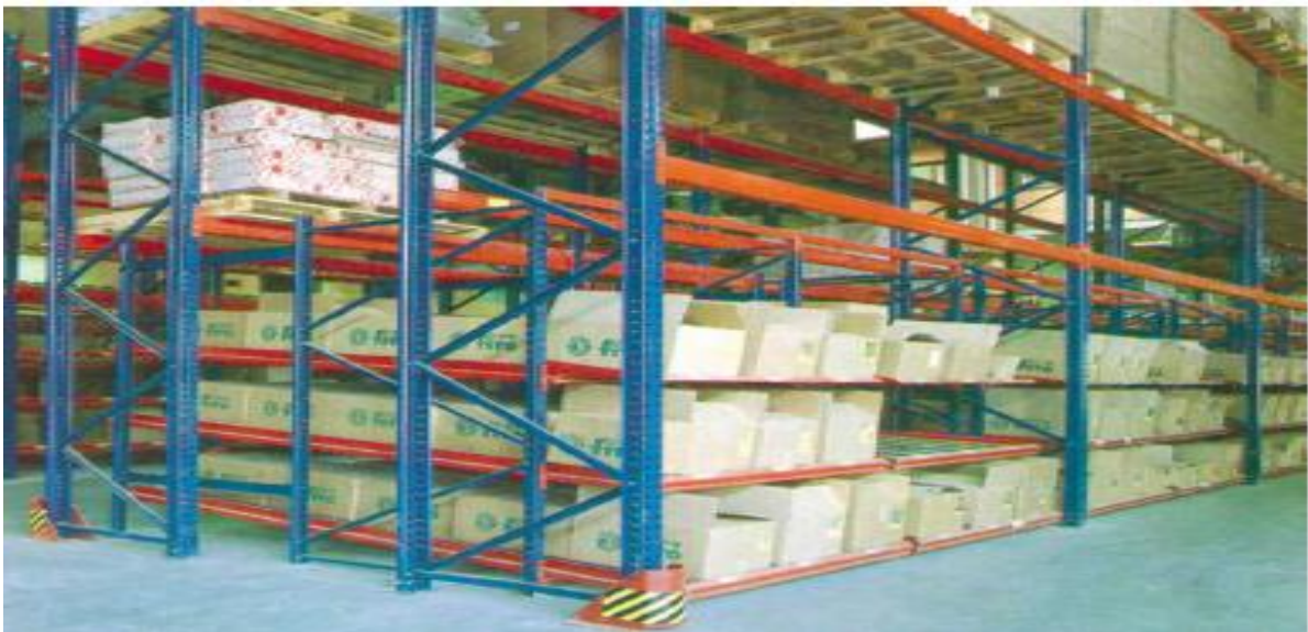
Figura 8: Exemplo de armazenagem com estrutura dinâmica.
