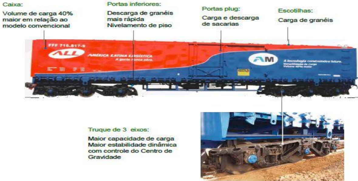
Figura 76: Vagão multi-carga. Fonte: Abate, 2012.
