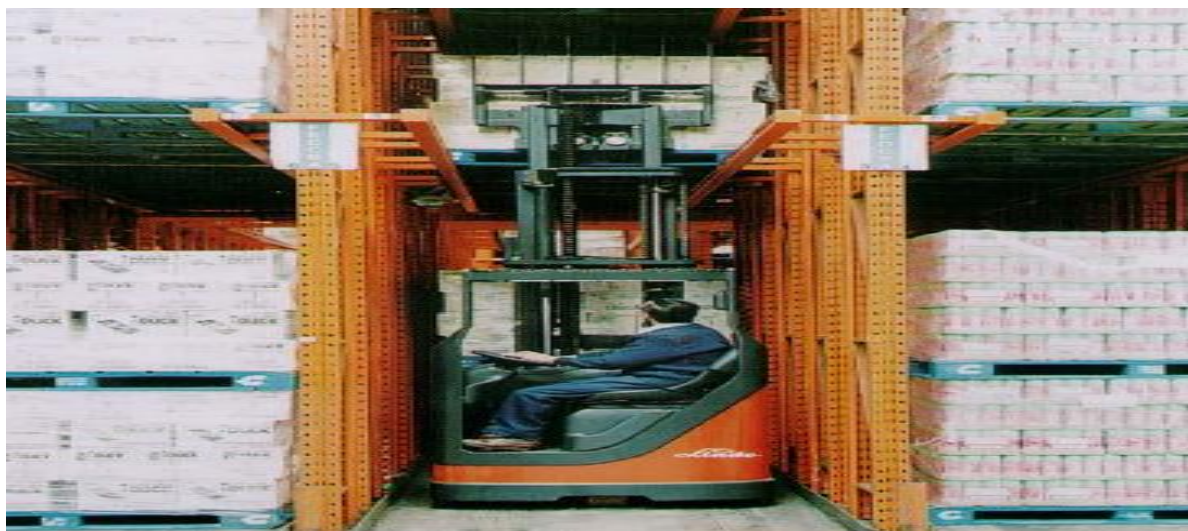
Figura 7: Exemplo estrutura de armazenagem drive-in.
