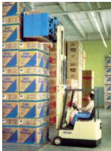
Figura 12: Exemplo de armazenagem com sistema de blocagem.
