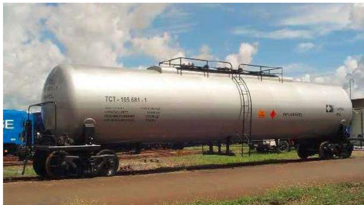
Figura 75: Vagão tanque com capacidade de 118.000 litros. Fonte: Abate, 2012.
