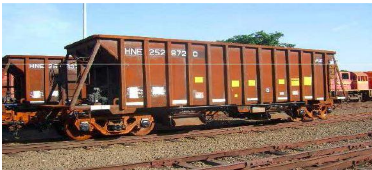
Figura 67: Vagão hopper para Lastro. Fonte: Abate, 2012.
