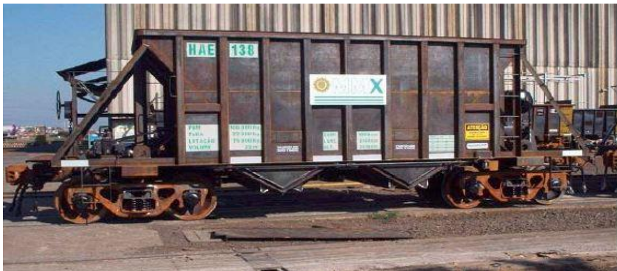
Figura 68: Vagão hopper para Manganês com portas automáticas a ar comprimido. Fonte: Abate, 2012.
