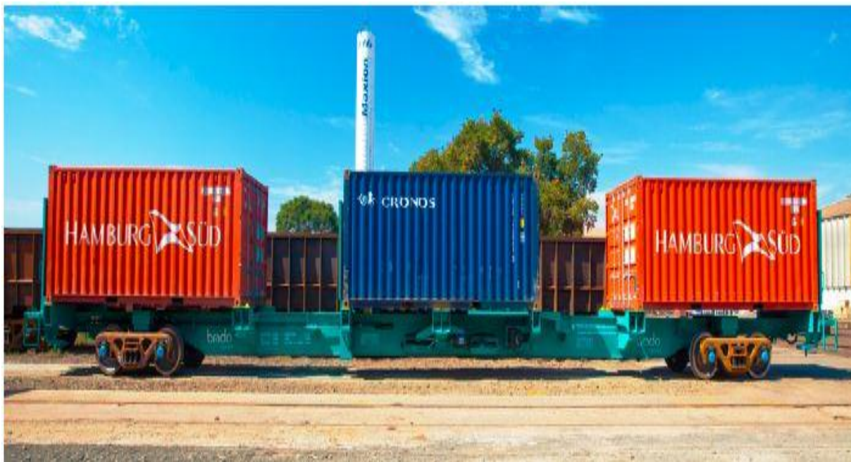
Figura 72: Vagão longo para contêiner. Fonte: Abate, 2012.
