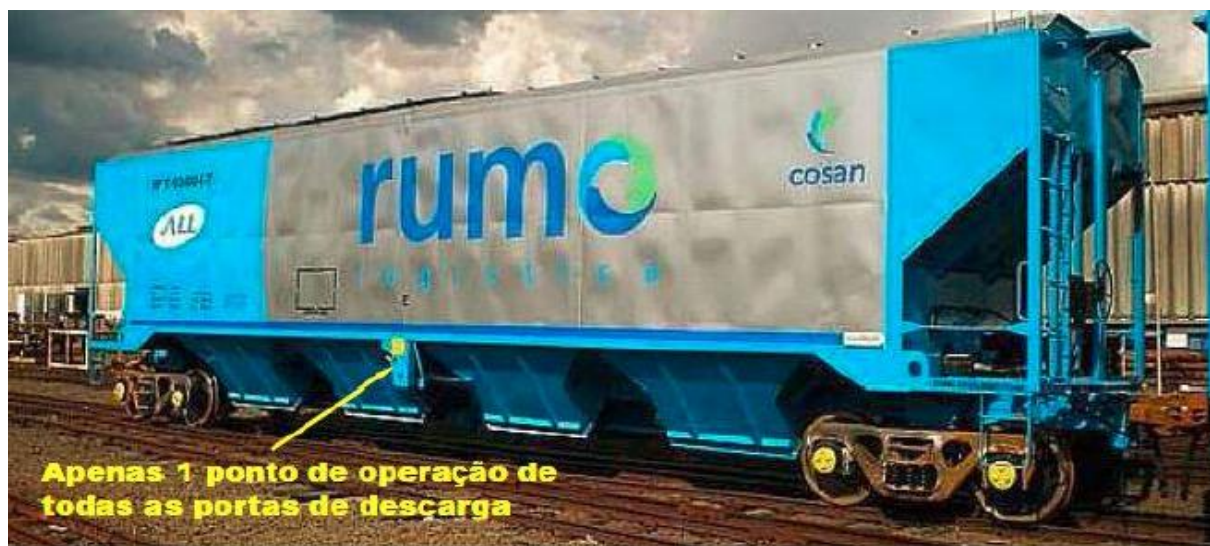
Figura 66: Vagão para açúcar. Fonte: Abate, 2012.
