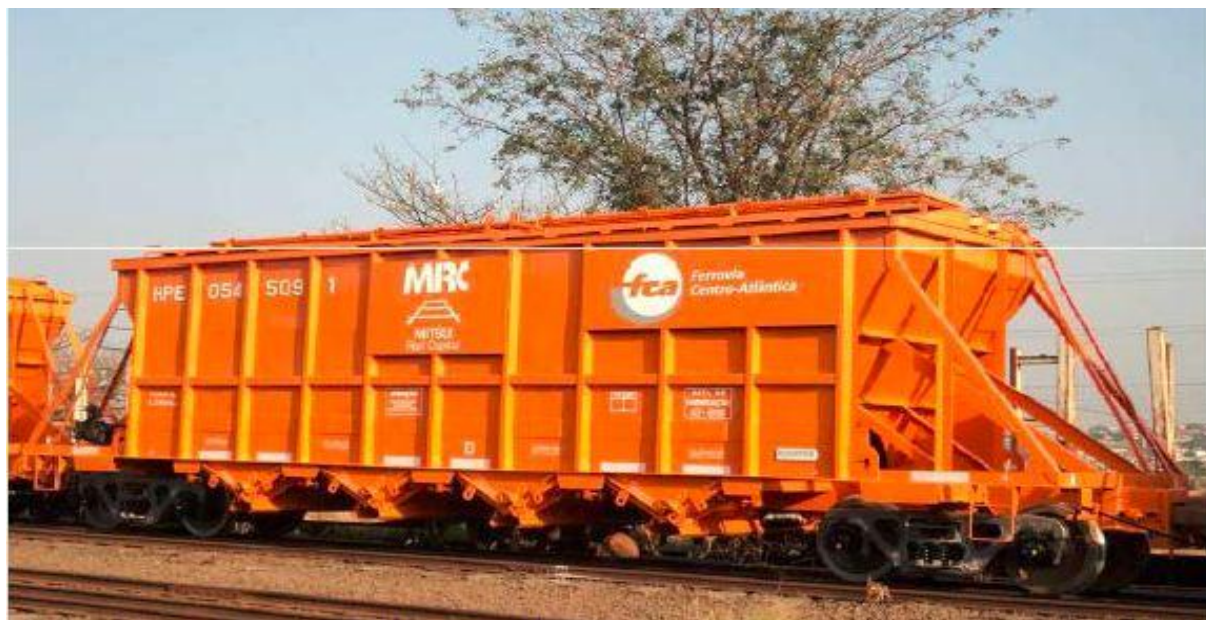
Figura 69: Vagão graneleiro para fertilizantes com descarga semi-automática. Fonte: Abate, 2012.
