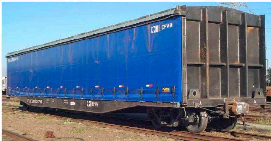
Figura 70: Vagão fechado all door específico aos terminais de celulose. Fonte: Abate, 2012.
