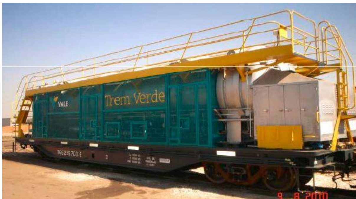
Figura 74: Vagão para o transporte de gás natural para locomotivas. Fonte: Abate, 2012.
