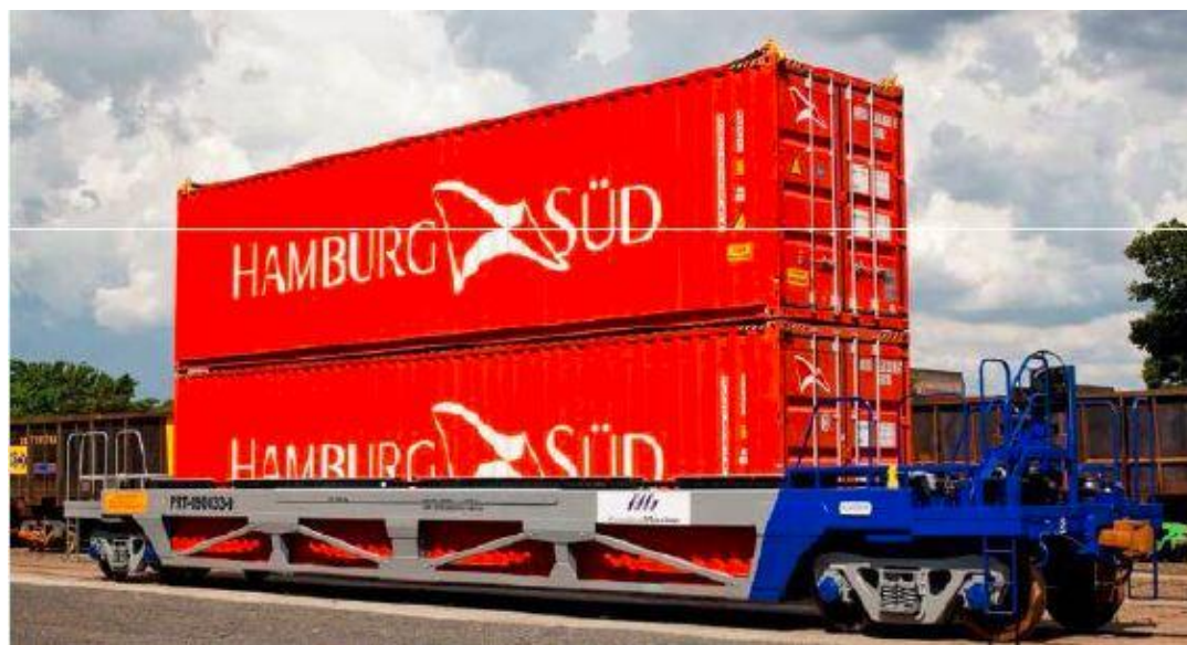
Figura 71: Vagão carregado com 2 contêineres empilhados. Fonte: Abate, 2012.
