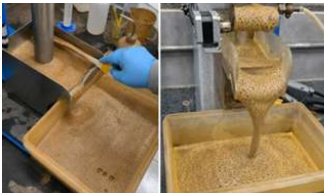
Flotação de nióbio no segundo (esq.) e terceiro (dir.) estágios de limpeza
