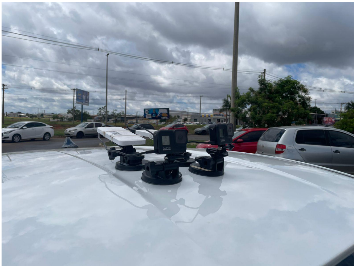
Figura 49 – Câmeras fixadas na parte superior do veículo que percorreu a Área de Estudo
