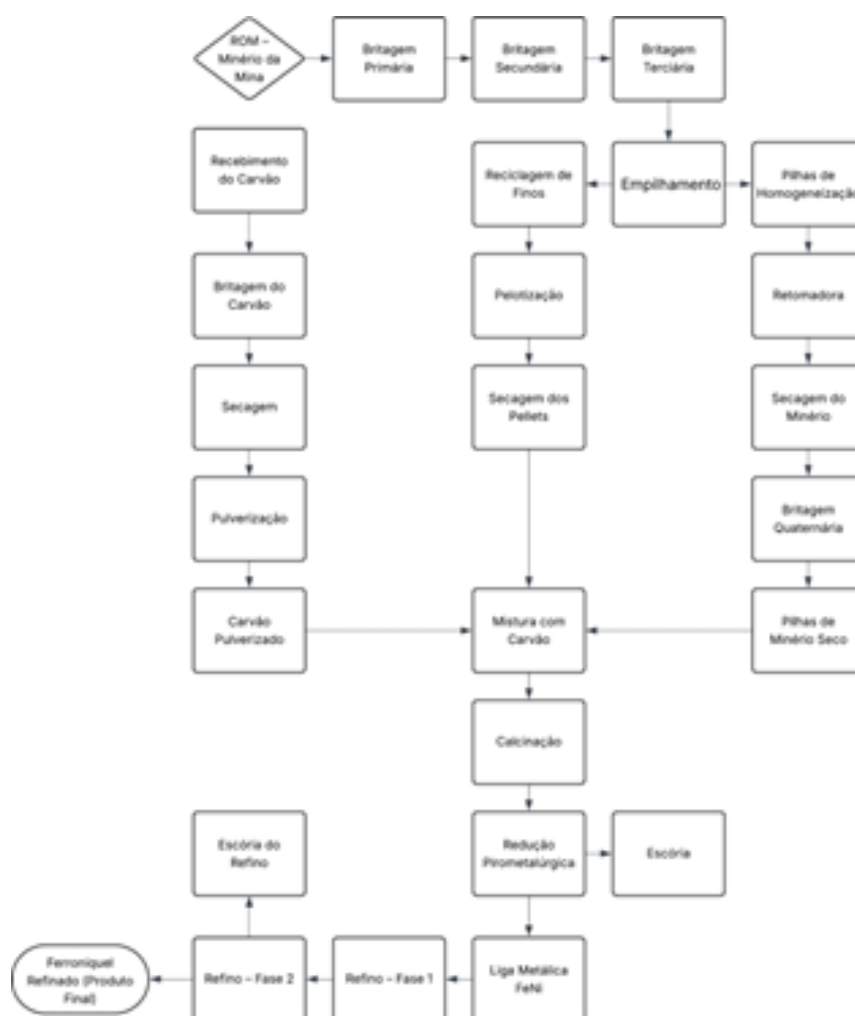
Figura 264 Fluxograma representativo da rota de processamento de níquel - Anglo Níquel Barro Alto.
