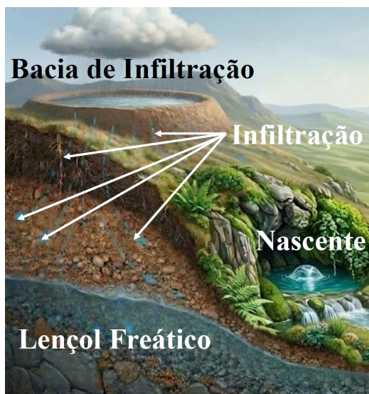
Figura 50: Funcionamento esquemático das bacias de infiltração.
