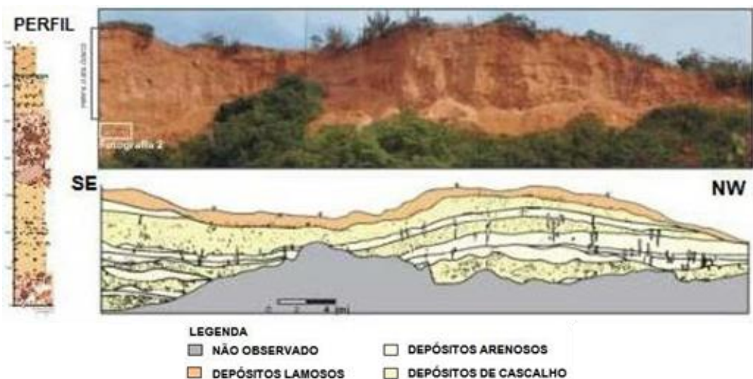
Figura 4 - Mapeamento geológico de encosta (Fonte: DNIT)
