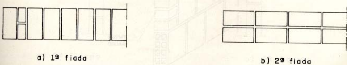
FIGURA 2 - Amarração das fiadas da parede de uma vez
