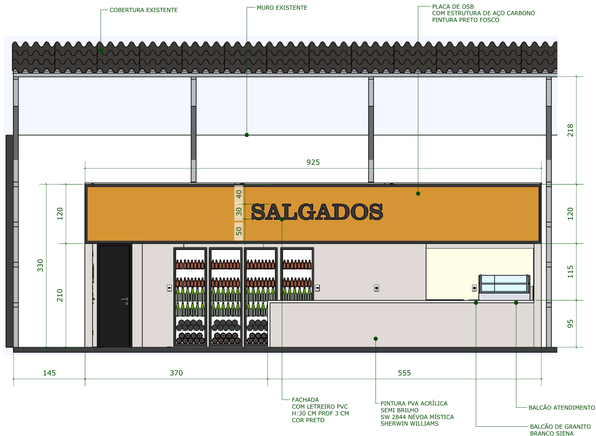
VISTA D FACHADA LANCHONETE ESCALA: 1/40
