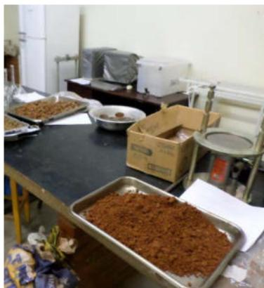
Figura 6 - Processo inicial de secagem de amostra em laboratório.
