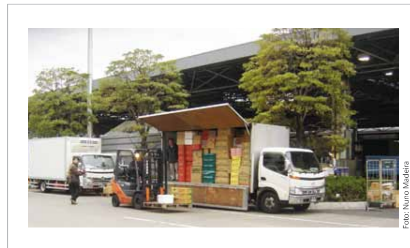
Figura 2 – Caminhão com carregamento lateral: agilidade de operação
