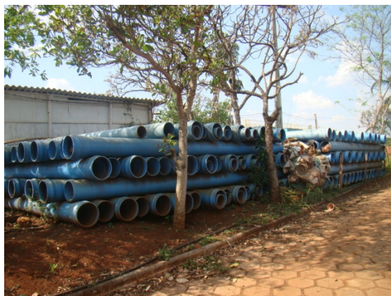
Foto 3 –Tubulação para novas adutoras
