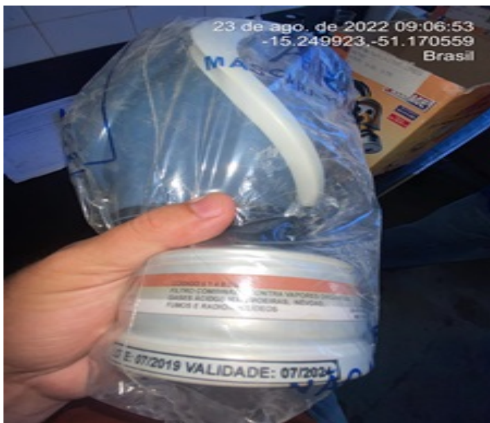
Foto 1 - ETA máscara de proteção com filtro novo e dentro do período de validade.
