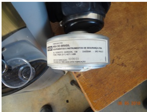
Foto 4 - Filtro da máscara de proteção para manuseio de cloro gasoso vencido.
