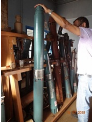
Foto 7 - Bomba adquirida para ser instalada no poço PGB 069.
