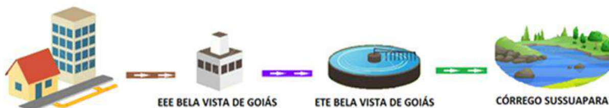
Figura 39 - Fluxograma do SES da Sede municipal – Bela Vista de Goiás.
