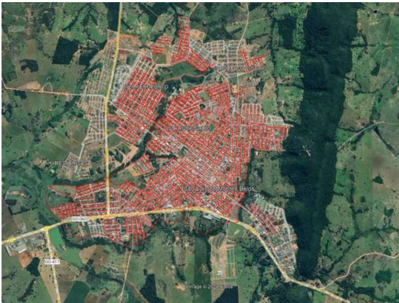
Foto 32 - Cadastro de rede de coleta de esgoto.
