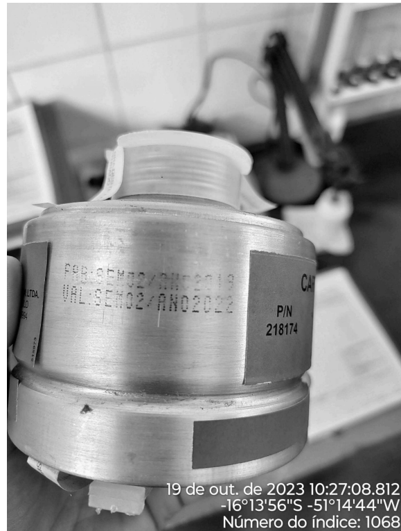
Foto 10 - Filtro da máscara de manuseio de cloro vencido (ETA).
