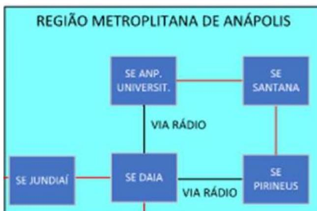
Figura 06: Representação da arquitetura redundante com canal de rádio (traçado preto) e de fibra ótica (traçado vermelho) para as Subestações Daia, Anápolis Universitário, Santana e Pirineus.
