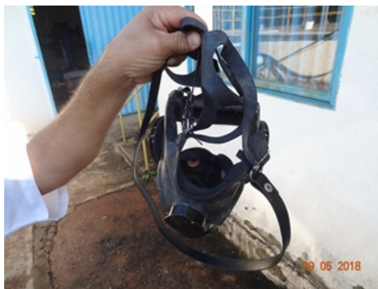
Foto 5 - Máscara para manuseio de cloro sem filtro
