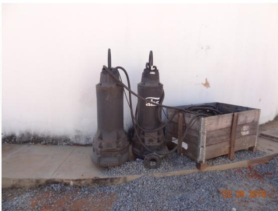
**Foto 2** - Bombas para captação permanente no Rio das Almas
