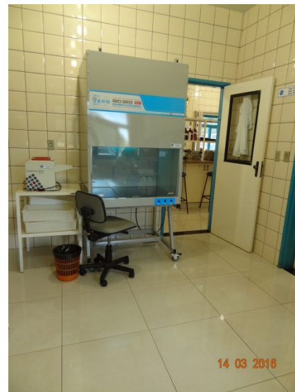
Foto 2 – Capela de filtro laminar para análises bacteriológicas
