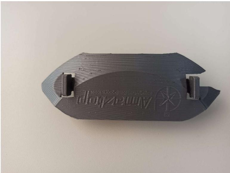
Foto 02 - Tampa do compartimento de bateria danificada.
