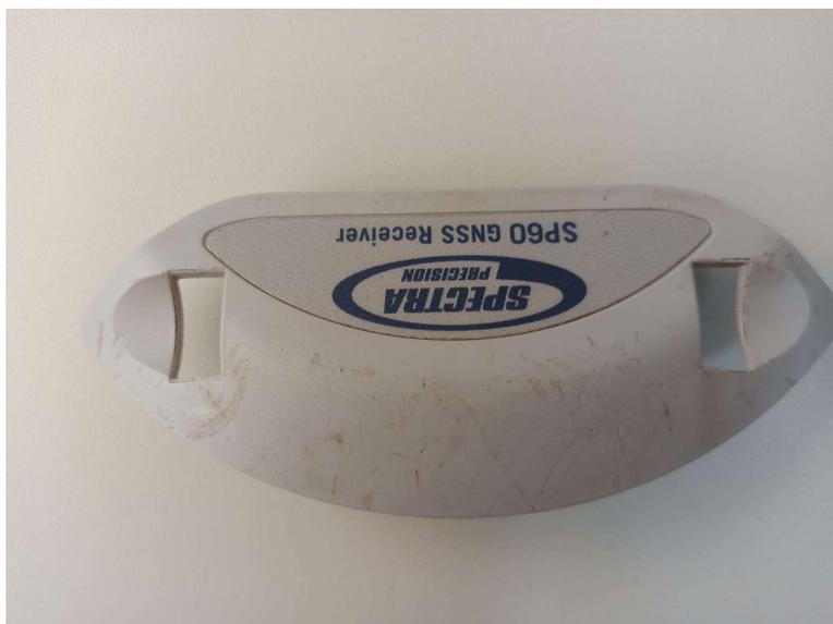
Foto 04 - Tampa com as duas presilhas de fixação quebradas.
