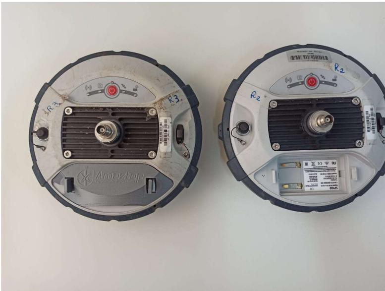
Foto 01 - GPS (com e sem tampa do compartimento de bateria).
