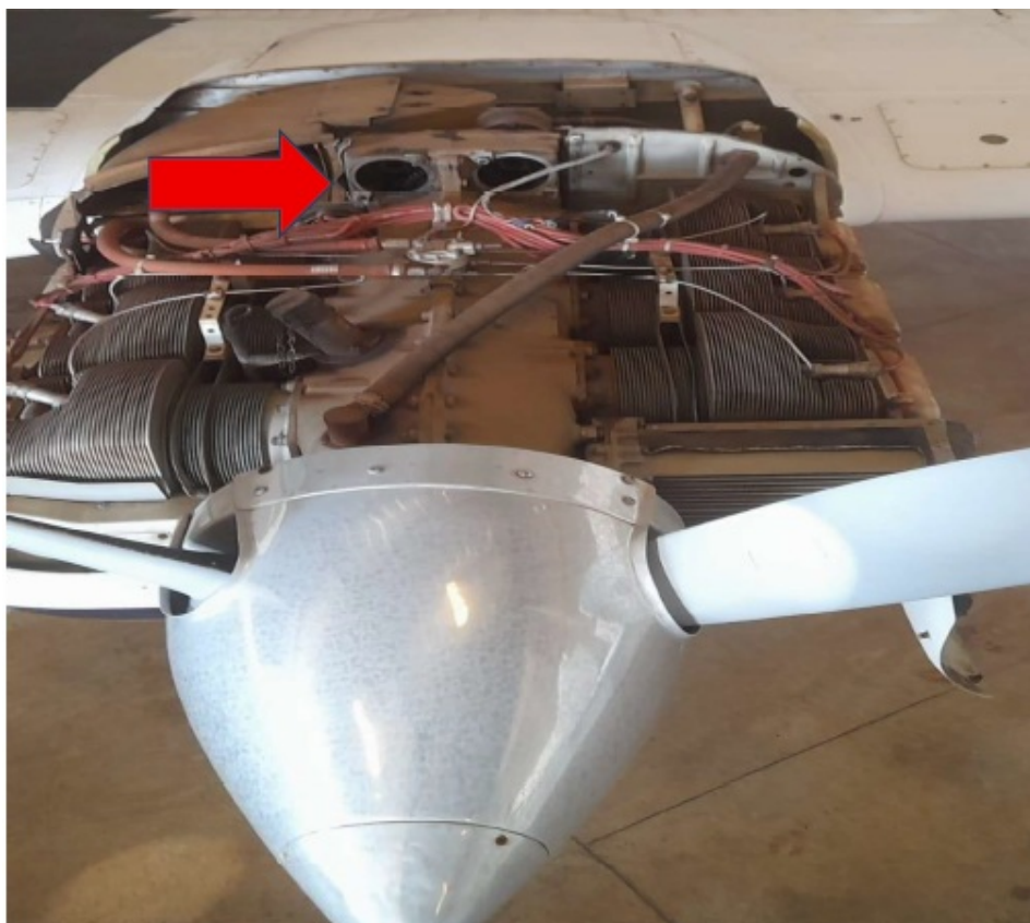
MAGNETOS DO MOTOR FALTANDO
