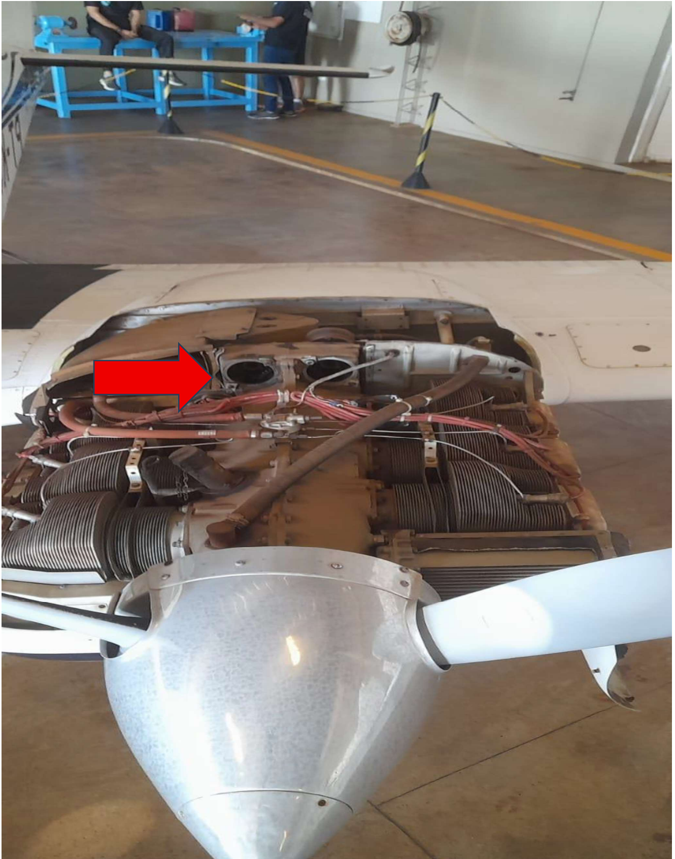
MAGNETOS DO MOTOR FALTANDO
