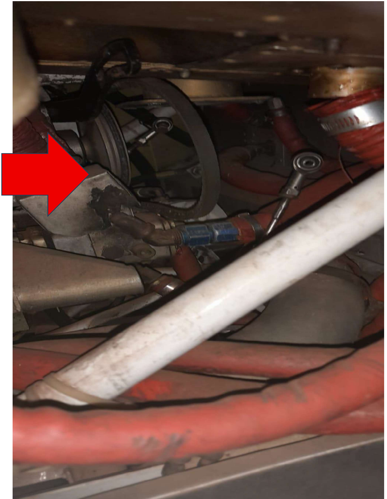
Faltando o alternador do motor
