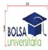
LETRA CAIXA EM AÇO GALVANIZADO PINTADO COM TINTA AUTOMOTIVA NAS CORES CORRESPONDENTES CORDA DO CAPELO EM ACRÍLICO PINTADO"
