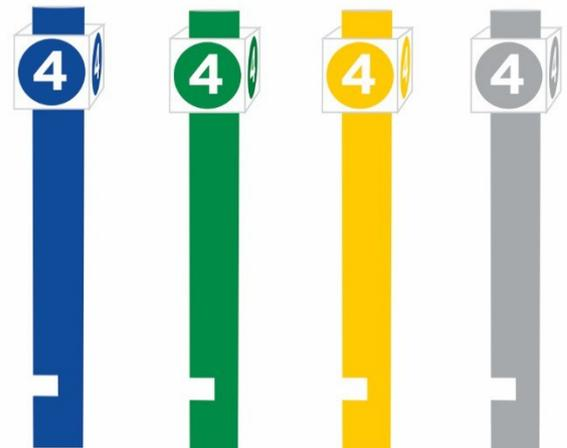
A solução sugerida para a sinalização de numeração dos guichês de atendimento foi a criação de uma peça que utiliza um suporte de tubo galvanizado encaixado na borda das mesas da estação de trabalho e uma estrutura em formato de cubo, na parte superior do tubo, para a marcação dos números.
