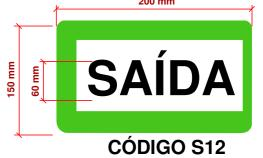
FUNÇÃO: INDICAR SAÍDA DE EMERGÊNCIA LOCAL: NAS PORTAS CORTA-FOGO OU LOCAIS ONDE SEJAM NECESSÁRIAS SINALIZAÇÃO COMPLEMENTAR A 1,80 m DO PISO. FORMA: RETANGULAR, COR DO FUNDO VERDE COR DO SÍMBOLO: FOTOLUMINESCENTE
