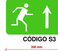
FUNÇÃO: INDICAR SAÍDA DE EMERGÊNCIA LOCAL: ROTAS DE SAÍDA, FIXADA NA PORTA A NO MÁXIMO 0,10 m ACIMA DA PORTA OU CENTRALIZADA NA PORTA A 1,80 m DO PISO. FORMA: RETANGULAR, COR DO FUNDO VERDE COR DO SÍMBOLO: FOTOLUMINESCENTE
