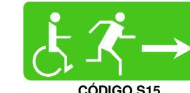
FUNÇÃO: INDICAR SAÍDA DE EMERGÊNCIA LOCÁL: LOCAIS ONDE SEJAM NECESSÁRIAS SINALIZAÇÃO COMPLEMENTAR A 1,80 m DO PISO. FORMA: RETANGULAR, COR DO FUNDO VERDE COR DO SÍMBOLO: FOTOLUMINESCENTE
